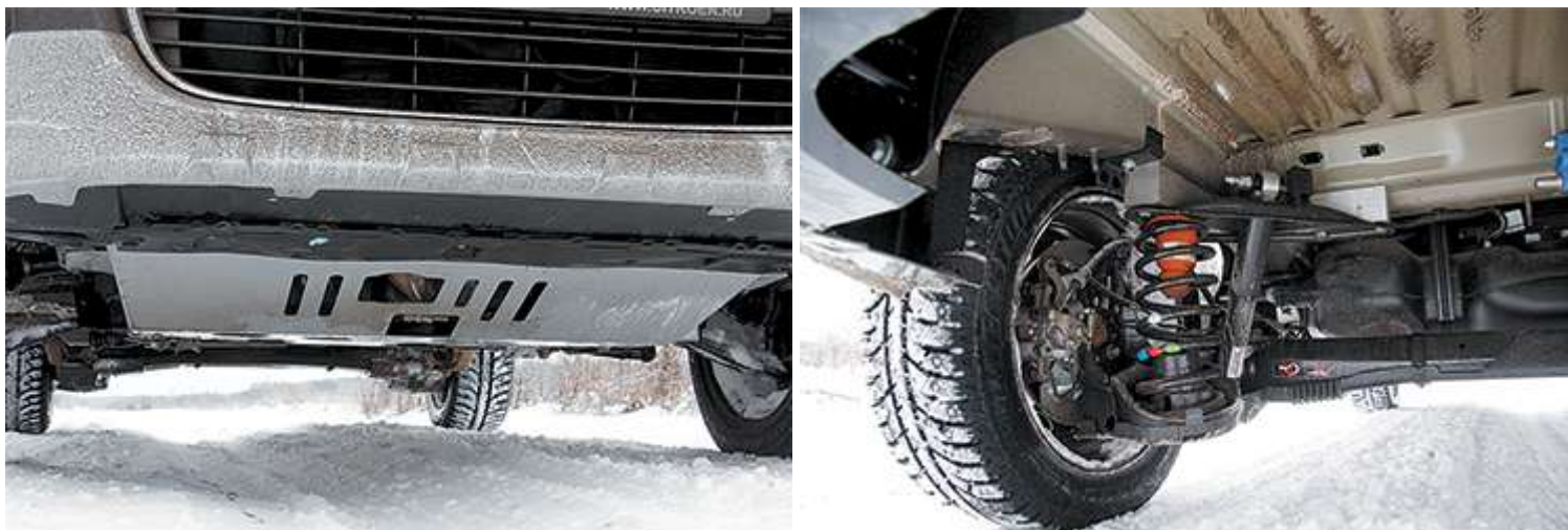
Под защитой картера — 200 мм. В районе задней балки — 215 мм!
